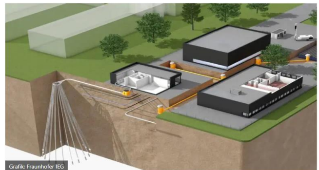
Abbildung 86: Schematische Darstellung von Erdsonden in Schrägbohrtechnik (GeoStar), entwickelt durch das Fraunhofer IEG.
